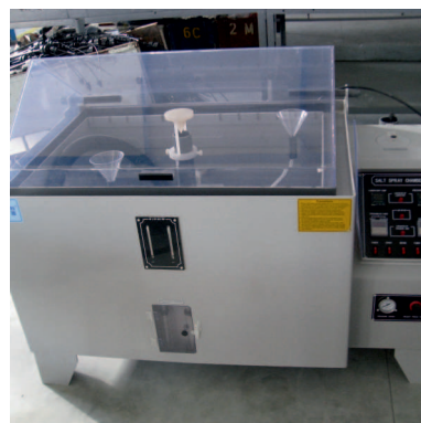
Banc d'essai de corrosion
