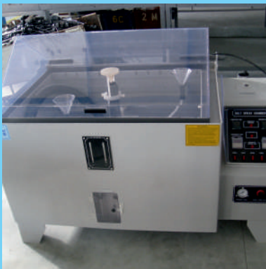
Banc d'essai de corrosion
